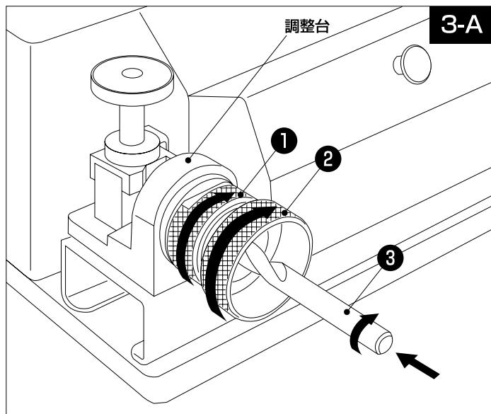
注意：この時必要以上の強い力で締め付けないようにしてください。調整台の故障やストップバーの磨耗の原因になります。
