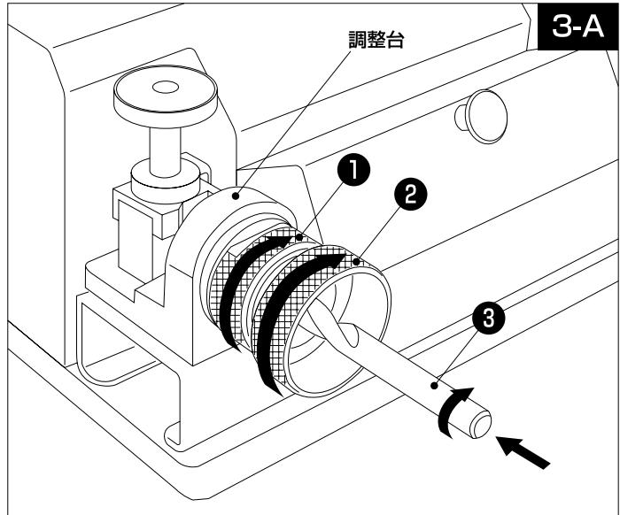
注意：この時必要以上の強い力で締め付けないようにしてください。調整台の故障やストップの磨耗の原因になります。
