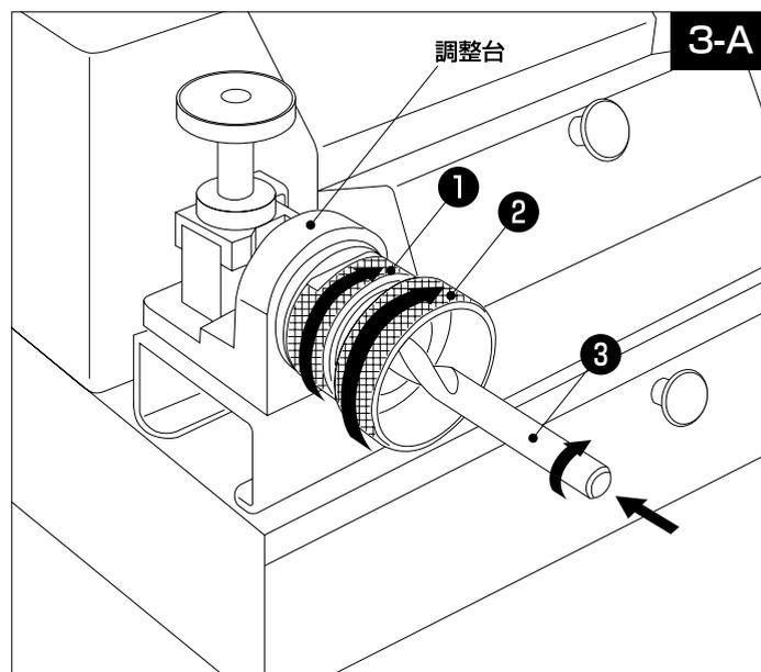
注意：この時必要以上の強い力で締め付けないようにしてください。調整台の故障やストッパーの磨耗の原因になります。
